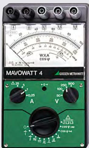
Ce wattmètre multiple permet de réaliser des mesures de puissance directes sur des courants continus ainsi que des mesures de puissance active sur des courants alternatifs monophasés ou triphasés équilibrés.
