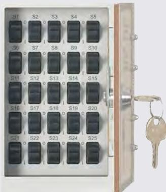
Simulateur de défaut avec 25 défauts possibles par commutateur
