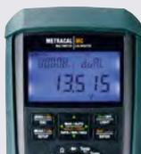
Éclairage de l'écran et écran multiple, p. ex. fonction et valeur de sortie ou valeur de mesure et de simulation, etc.
