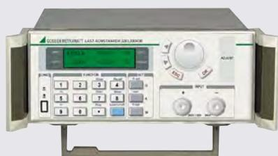
Les appareils de la série SSL (Single-Channel System Load) sont des charges électroniques programmables avec fonction de puits d'une puissance maximale de 150 ou 300 W. Elles servent à régler la charge des sources en courant continu en courant continu, résistance ou puissance constante. Leur domaine d'application s'étend aux tests des blocs d'alimentation, piles, modules PV, piles à combustible, etc.
