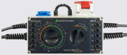
Adaptateur pour essai conforme aux normes des PRCD de types S et K par simulation des cas de défaut selon DIN VDE 0701-0702, VDE 0661, DGUV-I 203-006 et les indications du fabricant.
