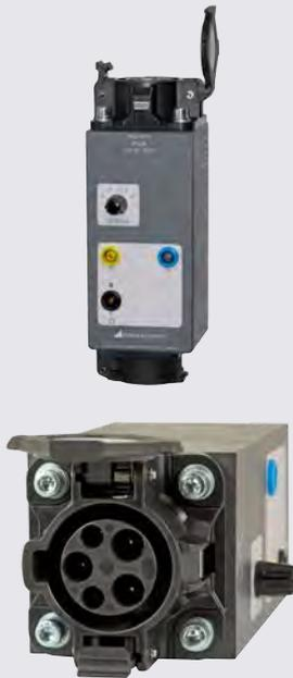
**Adaptateur de contrôle monophasé avec fiche de type 1 pour contrôler l'efficacité des mesures de protection sur les stations de recharge électriques avec le PROFITEST MTECH+ / MXTRA, simulation de véhicules électriques raccordés fictivement et simulation de la capacité de charge des garnitures de charge selon CEI 61851-1**
