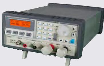
Les appareils de la série SPL (Single-Channel Programmable Load) sont des charges électroniques programmables avec d'excellentes propriétés de régulation dynamiques. Ils servent à régler la charge des sources en tension continue/ courant continu en courant constant, résistance, tension ou puissance. Leur domaine d'application s'étend aux tests statiques et dynamiques des alimentations électriques, piles, modules PV, piles à combustible, inductances, etc.
