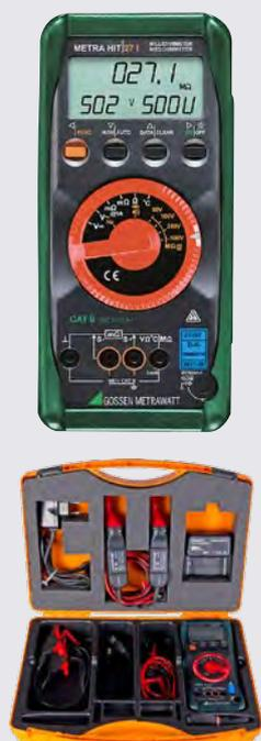
Testeur de résistance d'isolement, milliohm-mètre, multimètre à 4¾ positions et enregistreur. Un testeur d'isolement pour des mesures de l'ordre du gigaohm a été en plus intégré au milliohm-mètre-multimètre. Il existe de larges possibilités d'application, notamment dans le secteur aéronautique pour l'entretien et les réparations.
