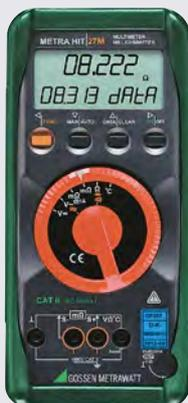
Milliohmètre et multimètre à 4¼ positions et enregistreur, instrument de mesure de la température pour la maintenance sur site et les tâches en laboratoire
