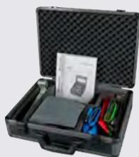
Cet appareil de mesure à piles détermine et mesure également les résistivités des sols et les résistances ohmiques selon la méthode de mesure courant-tension. Utilisation très simple et intuitive avec 4 touches seulement.
